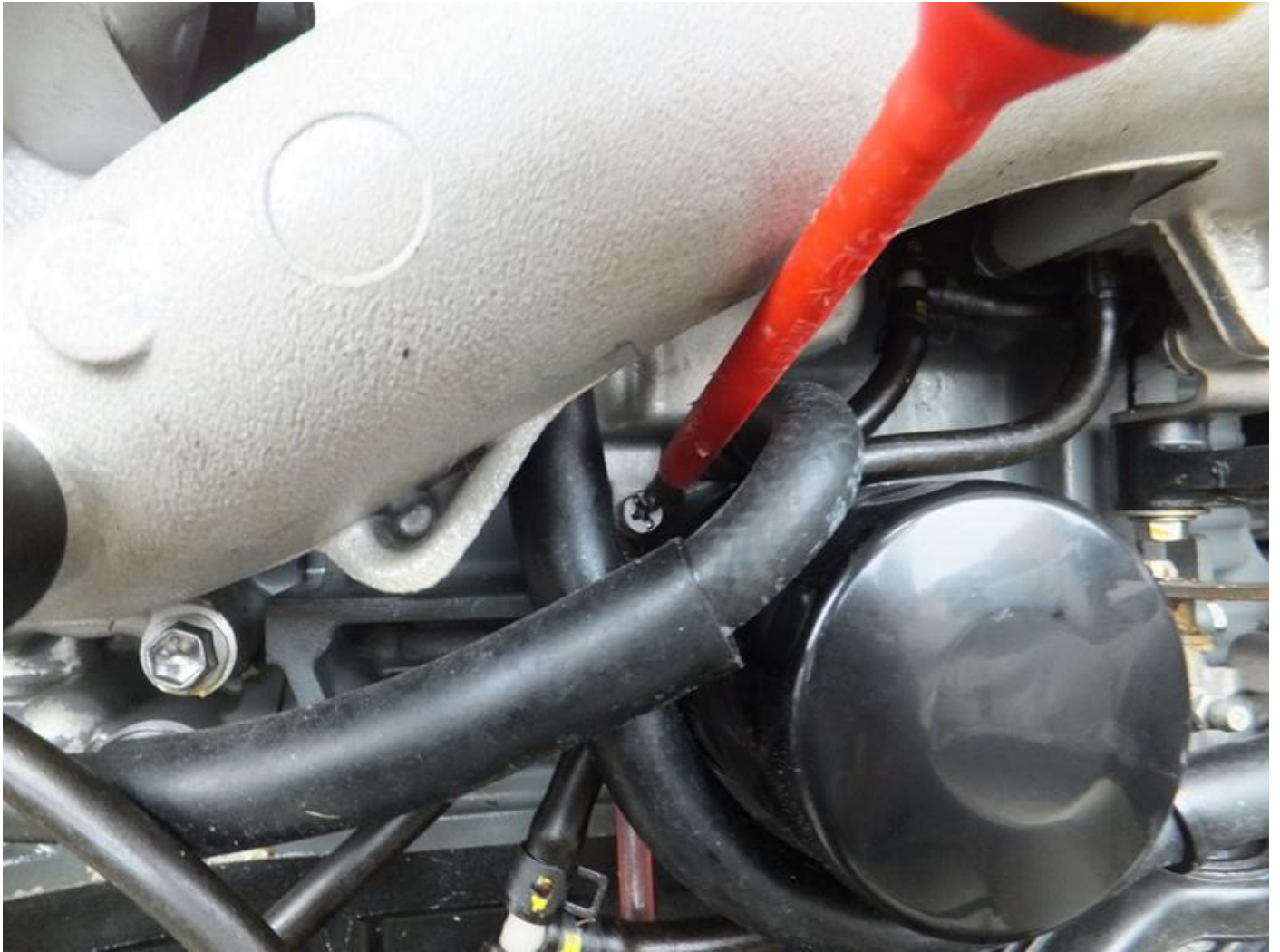
Purge du séparateur de vapeur essence
